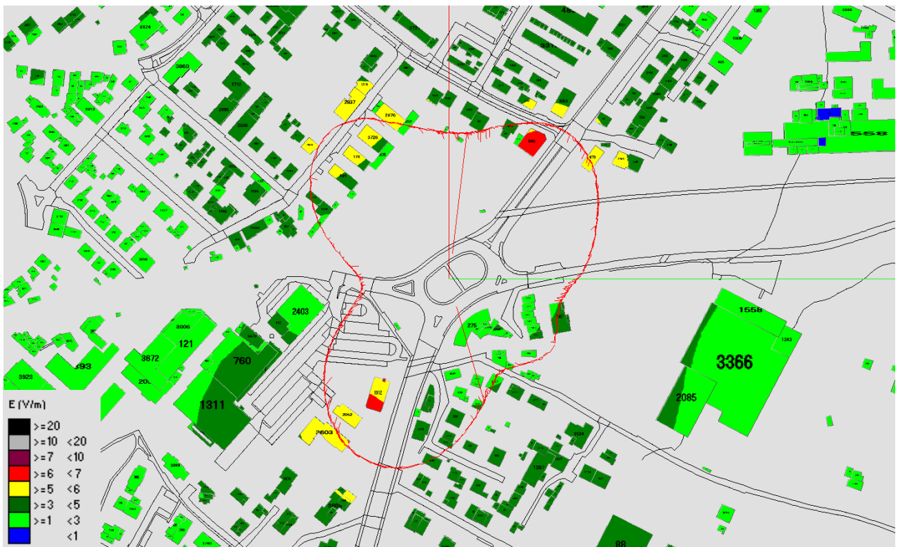
Fig. 63 Impatto elettrom. – zona Rotatoria Viale dell'industria - Via Paraiso – Vista dall'alto senza solido
